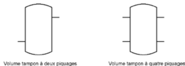
▲ Figure 1 : Vue de volumes tampons à deux et quatre piquages
